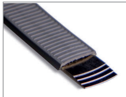
Recubrimiento SANTOPRENE® antiarañazos y fibra de aramida reforzada. 3 láminas de Acero Inoxidable + Kevlar®
